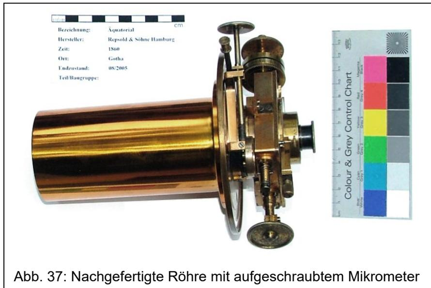
Abb. 37: Nachgefertigte Röhre mit aufgeschraubtem Mikrometer
