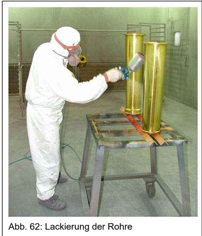
Abb. 62: Lackierung der Rohre
