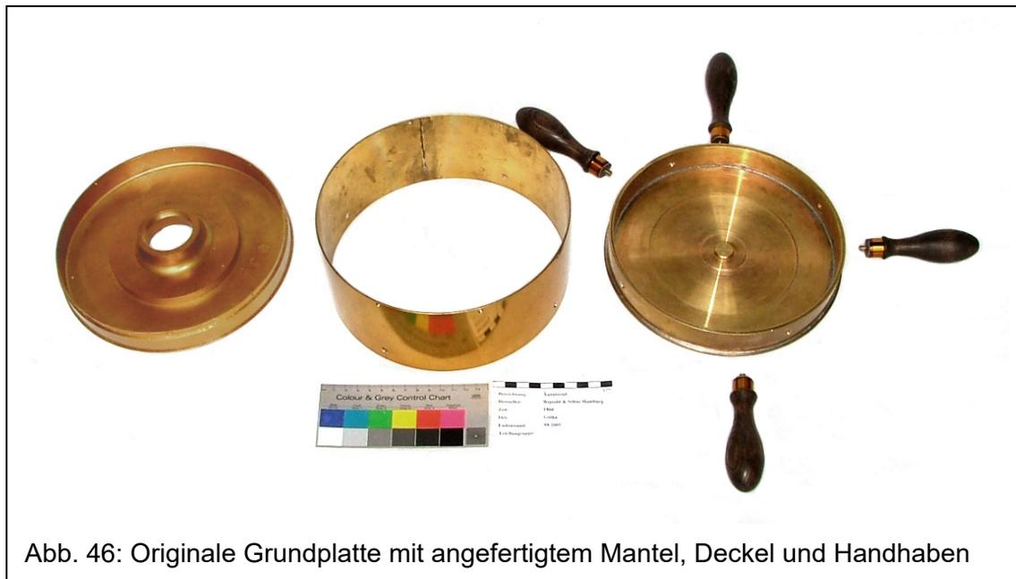
Der 4mm starke Messingstreifen erhielt Muttergewinde. So konnte der Deckel im Mantelblech fixiert und die Handhaben als letzter Montageschritt angebracht werden. An dieser Stelle sei deshalb noch einmal darauf hingewiesen, wie schwierig einerseits schon der Ankauf von geeignetem Material war und zum anderen die zum Teil sehr aufwendigen technischen Voraussetzungen zur Umsetzung einer fertigen Konstruktion.
