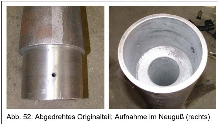
Abb. 52: Abgedrehtes Originalteil; Aufnahme im Neuguß (rechts)
